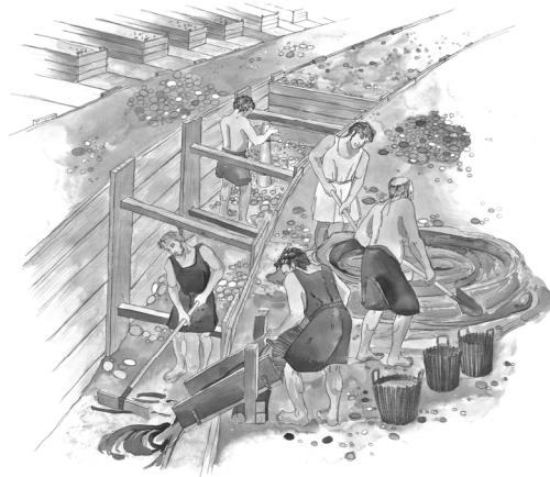
Figg. 8-9 Disegni delle principali fasi di cantiere per la costruzione delle fondazioni del teatro di Milano: riempimento delle fosse con ciottoli (fig. 8) e malta liquida (fig. 9). (Dis. di R. Rachini.)
